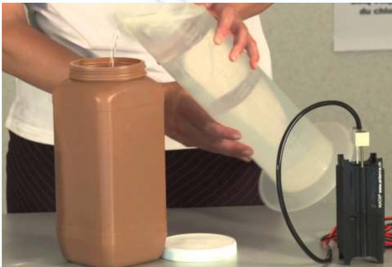
Expérience de désinfection de l'eau par L'hypochlorite de sodium
